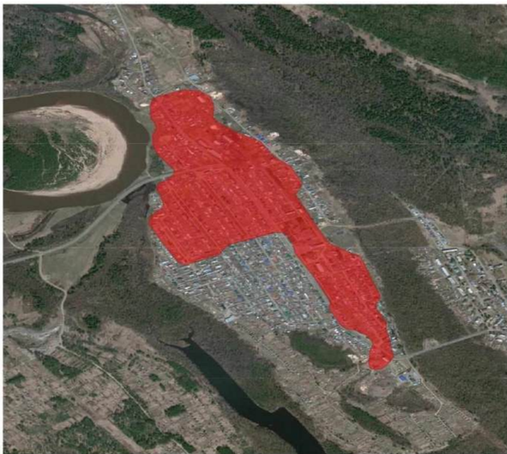
Рисунок 1.10. Существующая зона действия системы теплоснабжения с. Озерное
