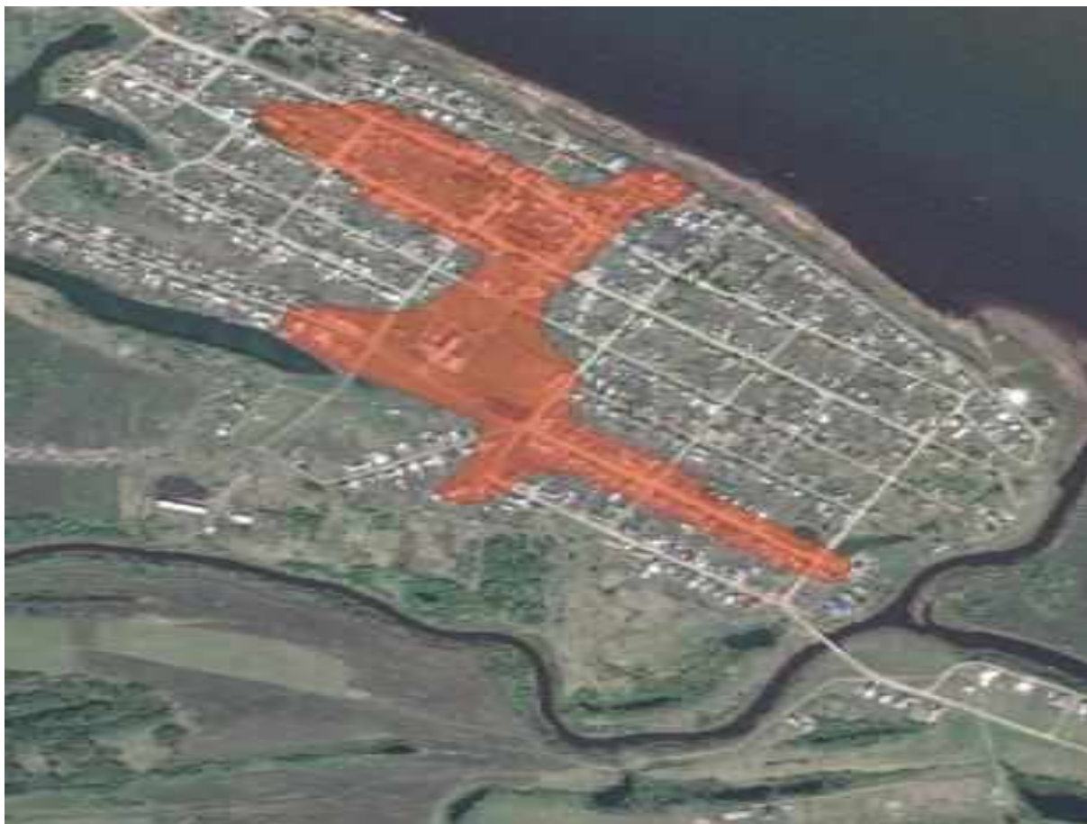
Рисунок 1.17. Существующая зона действия системы теплоснабжения с. Ярцево
