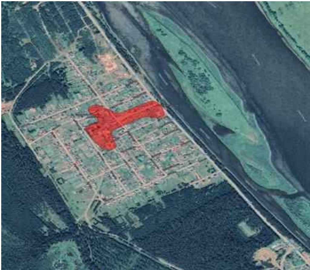
Рисунок 1.8. Существующая зона действия системы теплоснабжения п. Новокаргино
