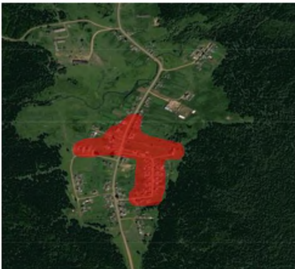
Рисунок 1.15. Существующая зона действия системы теплоснабжения с. Чалбышево
