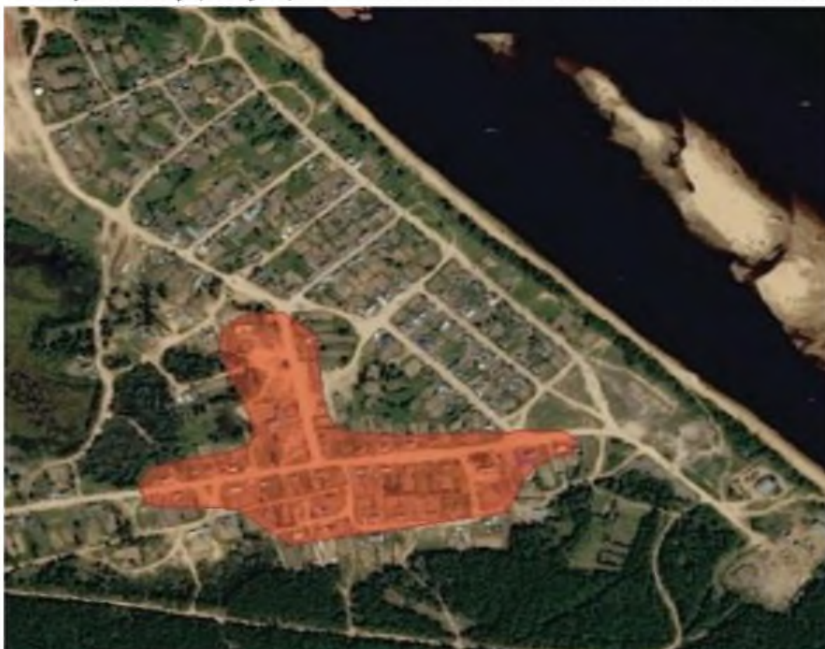
Рисунок 1.6. Существующая зона действия системы теплоснабжения п. Кривляк
